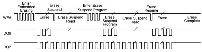
DQ2 toggles only when read at an address within an erase-suspended sector. The system may use OE# or CE# to toggle DQ2 and DQ6.
